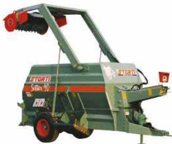
Slika 6. Mikser prikolica sa silo frezom za izuzimanjem silaže iz silo trenča
